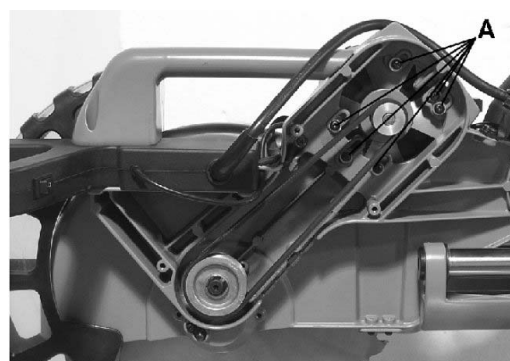
Obr. 17: Povolení šroubů motoru
