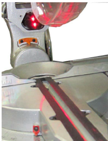
Obr. 4: Laser pro vyznačení linie řezu
