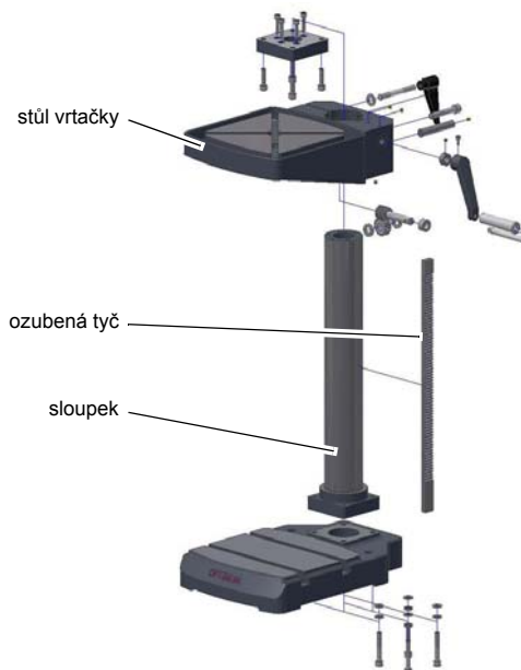
Obr.: 3-2: Montáž stolu vrtačky B24H (Vario)
