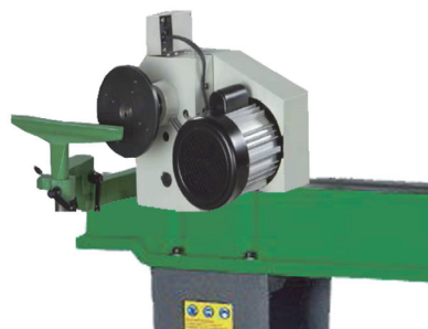
Obr. 15: Podpěra nástroje nalevo od vřeteníku
